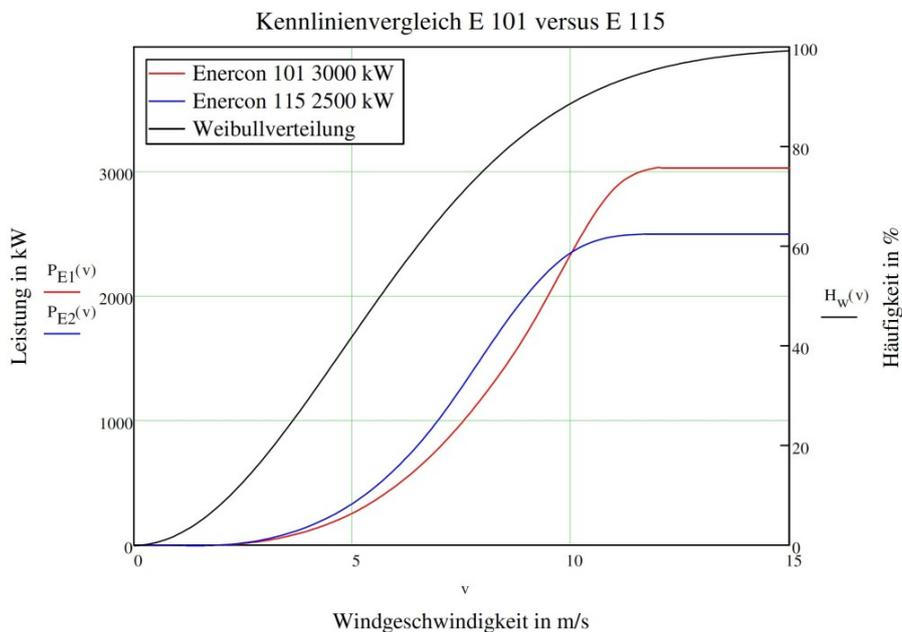
Abb. 3: Weibullverteilung und Rotorkennlinien Enercon 101 und 115
