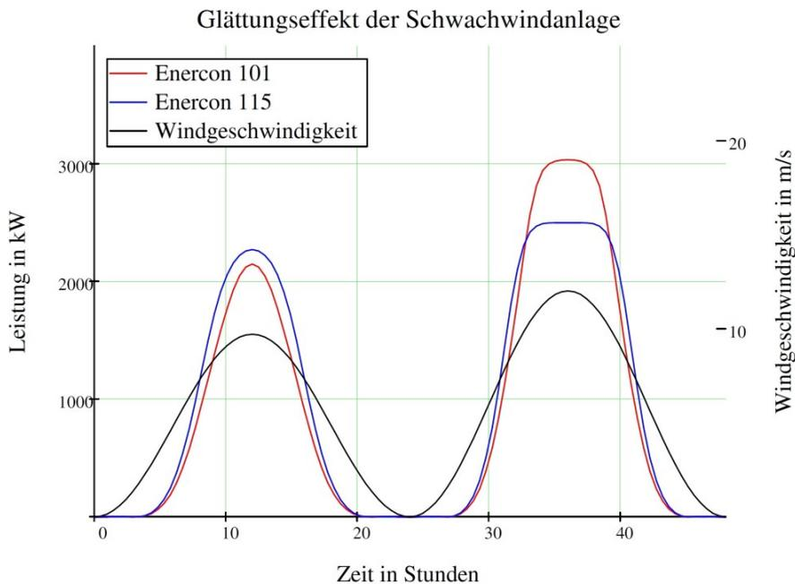
Abb. 2: Anstieg und Abfall von Windgeschwindigkeit und Leistung
